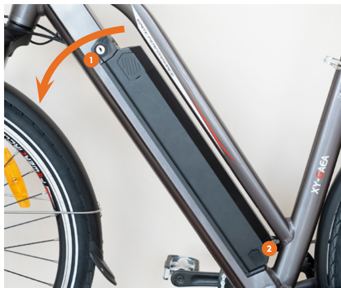
1. Zamek klucza blokady 2. Gniazdo ładowania
