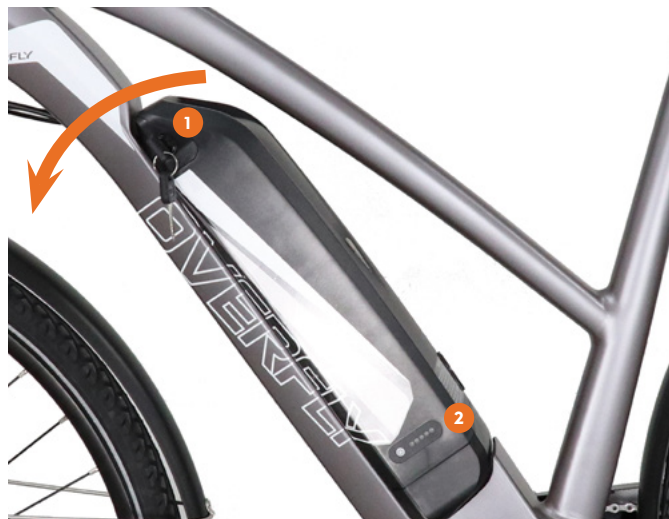
1. Zamek klucza blokady 2. Wskaźnik naładowania baterii
