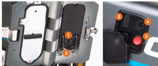
1. Blokada baterii 2. Uchwyt baterii 3. Gniazdo serwisowe 4. Gniazdo ładowania 5. Włacznik baterii
