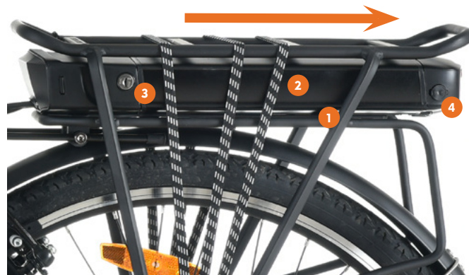
1. Bagażnik z gniazdem baterii 2. Bateria 3. Zamek klucza blokady 4. Gniazdo ładowania
