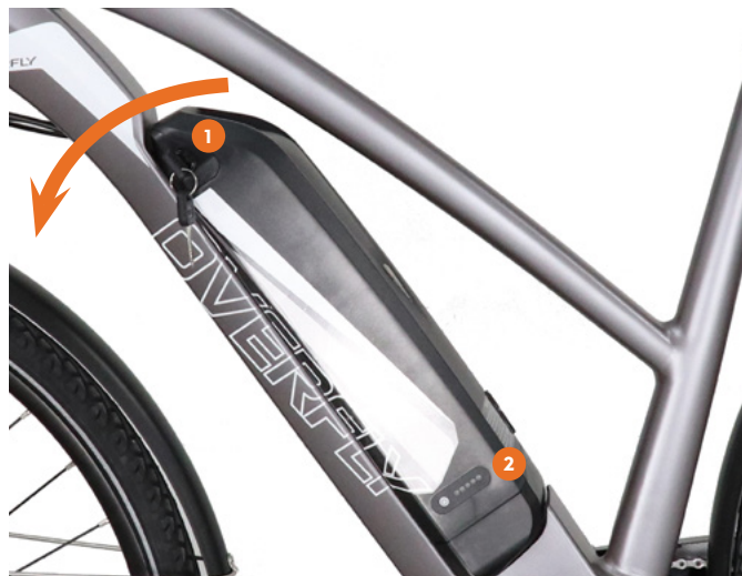
1. Zamek klucza blokady 2. Wskaźnik naładowania baterii
