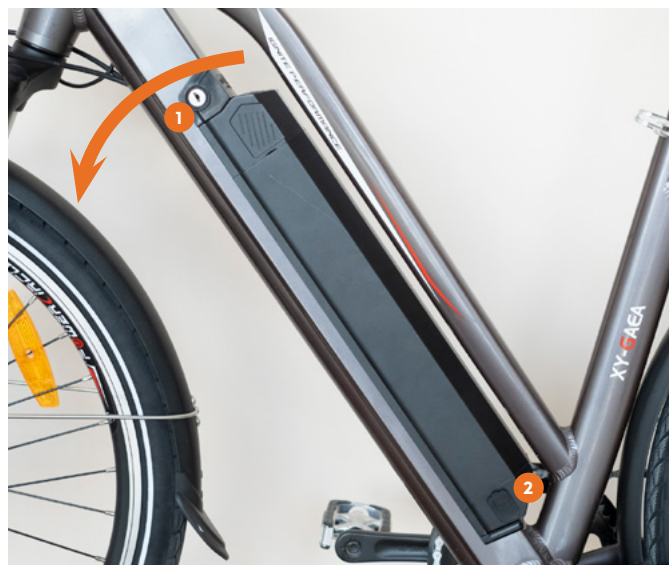
1. Zamek klucza blokady 2. Gniazdo ładowania
