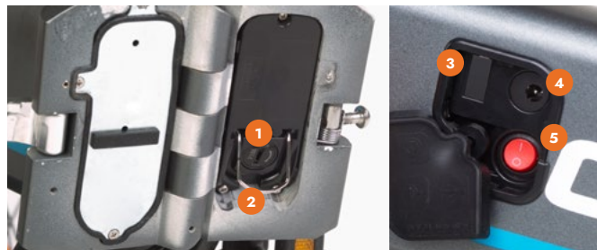
1. Blokada baterii 2. Uchwyt baterii 3. Gniazdo serwisowe 4. Gniazdo ładowania 5. Właczek baterii
