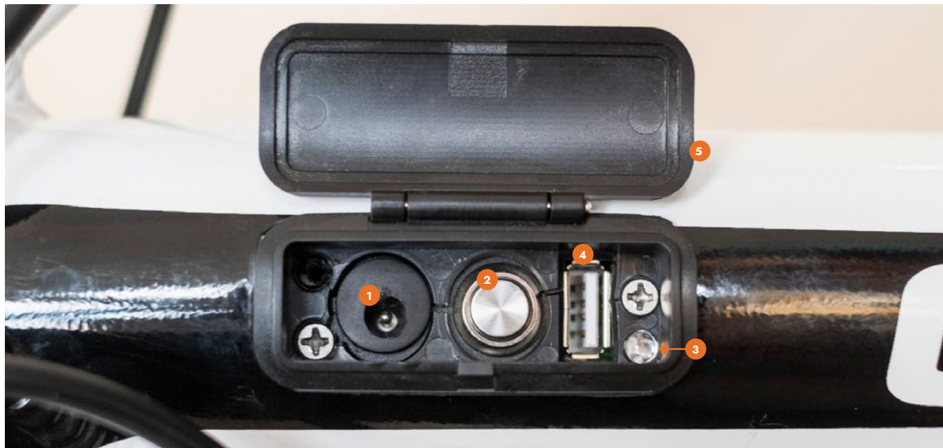
1. Port ładowania 2. Przycisk on/off 3. Dioda stanu naładowania baterii 4. Port USB 5. klapka
