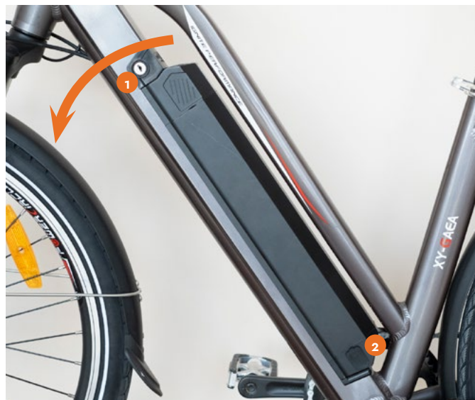
1. Zamek klucza blokady 2. Gniazdo ładowania
