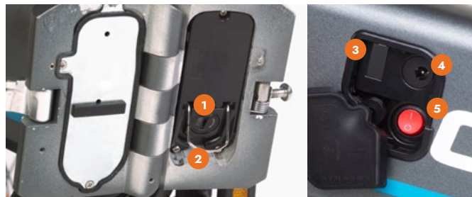
1. Blokada baterii 2. Uchwyt baterii 3. Gniazdo serwisowe 4. Gniazdo ładowania 5. Włącznik baterii
